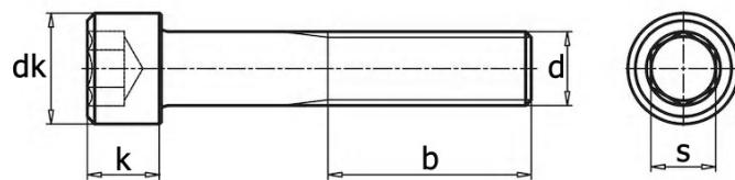
DIN 912 Винт с цилиндрической головкой и внутренним шестигранником.
